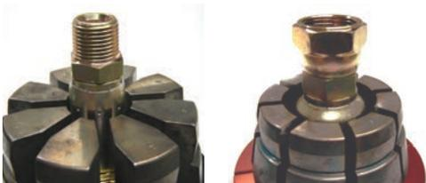
**5. Insérez le tuyau dans la machine à sertir..**
