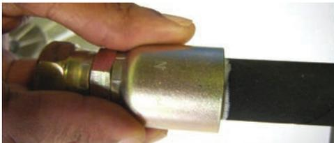
**4. Insérer le raccord dans le tuyau..**
