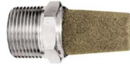
Les silencieux d'échappement utilisent un élément filtrant en bronze fritté poreux, fixé sur des raccords en acier plaqués nickel. Ils sont utilisés pour diffuser l'air et atténuer le bruit provenant des ports d'échappement des vannes à air, des cylindres à air et des outils pneumatiques, afin de le réduire à un niveau acceptable selon les exigences de bruit de l'OSHA. Ils sont également utilisés comme filtres pour l'essence, l'huile, et les échappements et admissions d'air.
