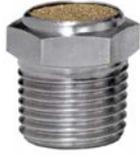
Orifices de ventilation à profil bas utilisés sur des cylindres ou des vannes à simple effet, avec filetage pour pipe ou filetage pour joint torique, pour empêcher la saleté et les particules étrangères d'entrer dans les ports ouverts à l'atmosphère. Ils sont également utilisés pour le soulagement du vide dans l'équilibrage de pression des boîtes de vitesses, des carters de moteur, des réservoirs de stockage ou des réservoirs.
