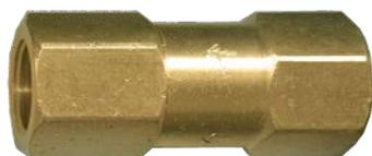
Clapet anti-retour à 3000 PSI. Poussoir et ressort en acier inoxydable, joint en Viton - Pression de déclenchement inférieure à 1 PSI. Les clapets anti-retour Maxi-Flow sont utilisés dans les applications où le reflux n'est pas permis. Peut être utilisé pour l'air ou les fluides (Cette vanne est destinée uniquement à un usage avec l'air et l'eau). Installer la vanne dans le sens de la flèche indiquée sur la pièce.
