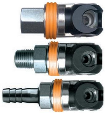
Le raccord à pivot interchangeable industriel offre un débit complet, une échappée de sécurité, une fonction de verrouillage, et permet de se connecter et de se déconnecter sous pression. **Pression de fonctionnement : 360 PSI (25 BAR).**"
